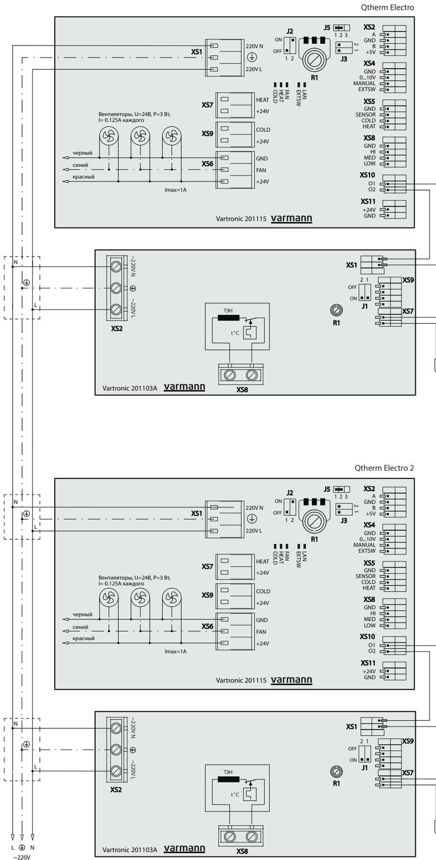
Ручная схема регулирования конвекторов Qtherm Electro позволяет плавно изменять и устанавливать нужную скорость вращения вентиляторов. Скорость устанавливается переменным резистором R1 на плате 201115. При этом регулирование нагревом ТЭН, осуществляется в автоматическом режиме силовой платой управления ТЭН в зависимости от установочной температуры воздуха переменным резистором R1 на плате 201103А.
