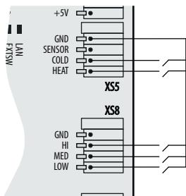
**Для перевода базовой платы конвектора тип 201125 в режим работы релейного управления, необходимо установить положение микропереключателей J2.1—OFF, J2.2—OFF.**
