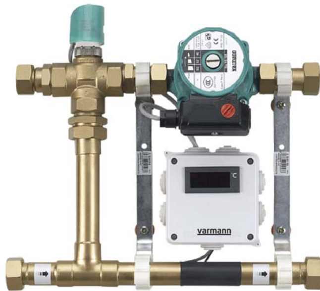
Узел регулирования температуры в контуре отопления или теплого пола в комплекте с электронным блоком, датчиком температуры подающей линии, насосом, трехходовым распределительным клапаном. Технические данные и стоимость по-запросу.
