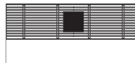
Вырез под колонну в середине конвектора
