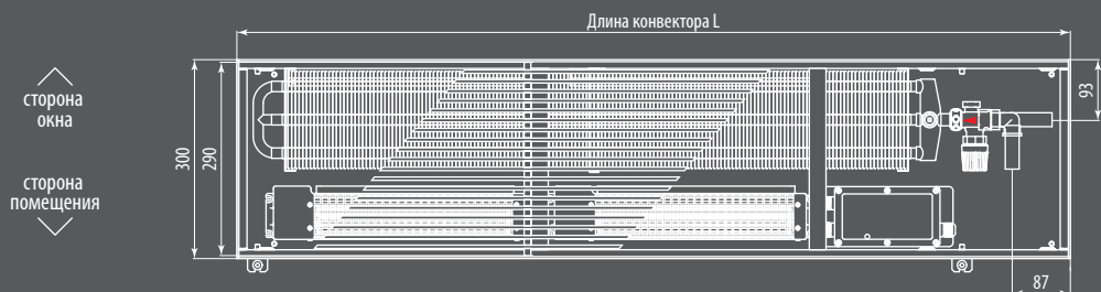
Вид сверху конвектора Qtherm 300.150 с линейной решеткой с U-образным бортом
