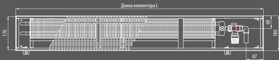
Вид сверху конвектора Ntherm Maxi 180 с роликовой решеткой с U-образным бортом
