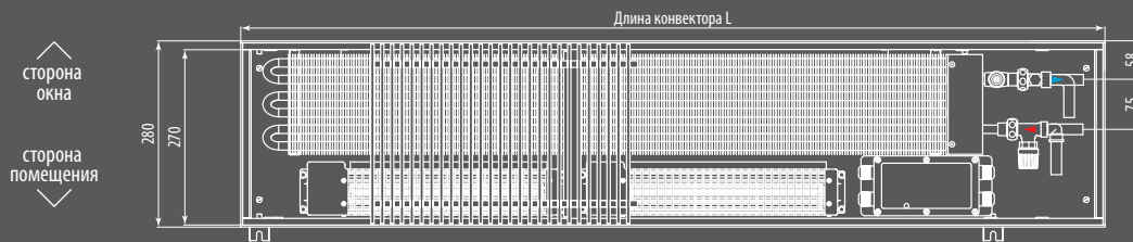
Вид сверху конвектора Qtherm Eco 280.90 с линейной решеткой с U-образным бортом, с дренажом
