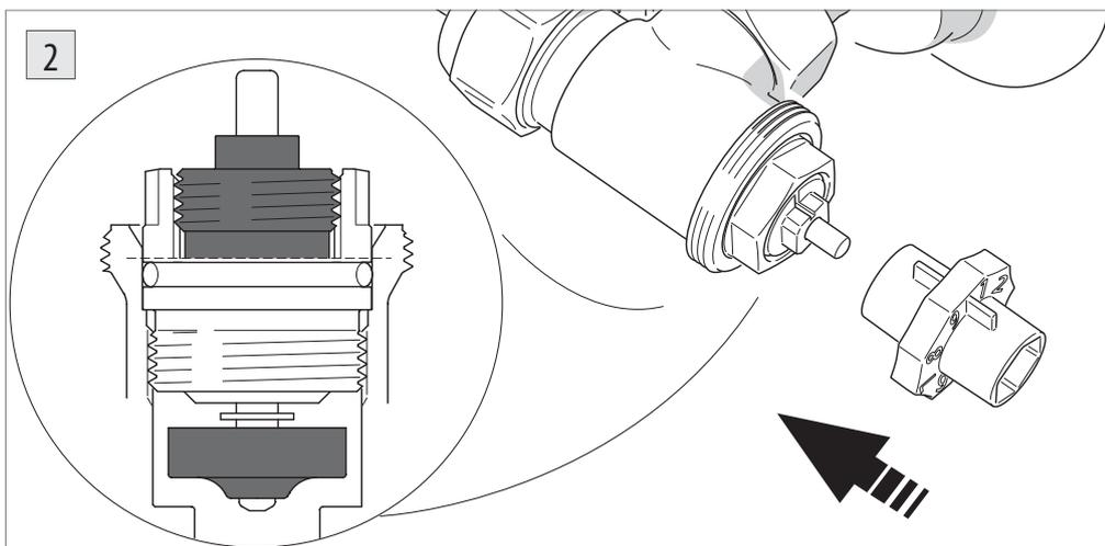
Выверните вентильную вставку термостатического вентиля до упора. Используйте для вращения вентильной вставки гаечный ключ на 8 или специальное приспособление.
