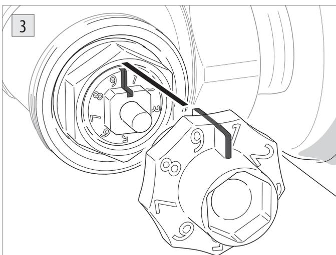
Установите приспособление в вентильную вставку так, чтобы шкала на приспособлении и вентильной вставке соответствовали друг другу.
