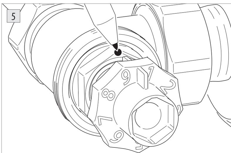
Установите метку маркером на корпусе вентильной вставки на нулевое положение.
